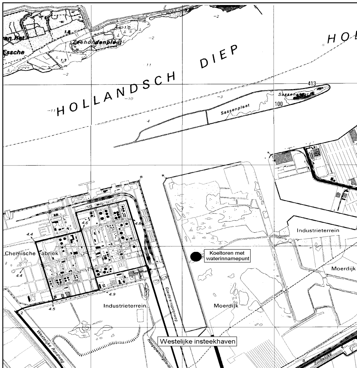
Figuur 1. Westelijke insteekhaven. De insteekhaven mondt uit op het Hollandsch Diep en is ca 2000 meter lang, 250 meter breed en is gemiddeld 10 meter diep. Op de oostoever staat een energiecentrale die het koelwater uit de haven betreft.
